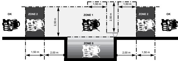
Installare la pompa in un locale ventilato e asciutto, poiché il motore richiede che l'aria circoli liberamente attorno ad essa, per consentirne la ventilazione naturale. Lasciare uno spazio vuoto di almeno 0,5 m tutto intorno alla pompa. Verificare regolarmente che il dispositivo di raffreddamento del motore non sia ostruito da oggetti, foglie o altri ingombri.
