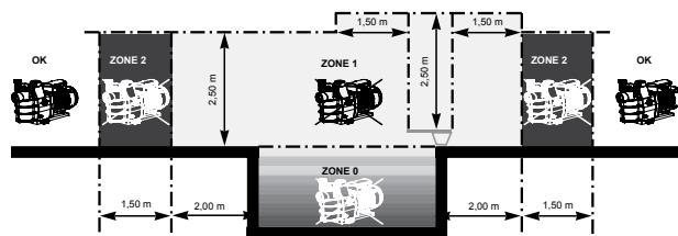
De pomp in een verluchte en droge ruimte installeren, de lucht moet vrijelijk rond de motor kunnen circuleren zodat hij op natuurlijke wijze verlucht kan worden. Voorzie een ruimte van minimum 0,5 m rond de pomp. Regelmatig controleren of de motorkoeling niet verhinderd wordt door voorwerpen, bladeren of andere obstakels.
