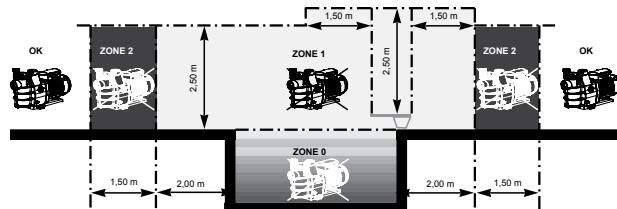
Instalar la bomba en un local ventilado y seco, el motor exige que el aire circule libremente alrededor de la bomba para que se ventile naturalmente. Prever un espacio libre de 0,5 m como mínimo alrededor de la bomba. Comprobar regularmente que no haya objetos, hojas o cualquier otro obstáculo que pudiese obstruir la refrigeración del motor.
