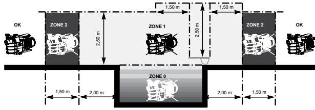
Installer la pompe dans un local ventilé et sec, le moteur exige que l'air circule librement autour de celle-ci pour permettre sa ventilation naturelle. Prévoir un dégagement minimum de 0,5 m autour de la pompe. Vérifier régulièrement que des objets, des feuilles ou tout autre encombrant ne viennent pas obstruer le refroidissement du moteur.
