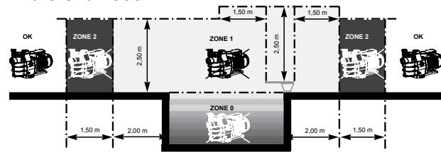
Installer pumpen i et tørt lokale med god ventilation, da motoren kræver, at luften kan cirkulere frit omkring den og skabe naturlig ventilation. Der skal være en friplads på 0,5 m omkring pumpen. Se jævnligt efter, at genstande, blade eller andet ikke kan komme til at hindre afkøling af motoren.
