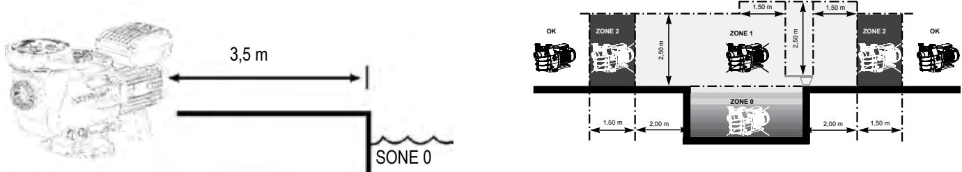
Installer pumpen på et luftet, tørt rom. Forutse fritt rom på 0,5 m rundt pumpen. Motoren krever at luften sirkulerer fritt rundt pumpen slik at den luftes naturlig. Sjekk regelmessig at verken gjenstander, blader eller noe annet tilstopper motorens kjølesystem.
