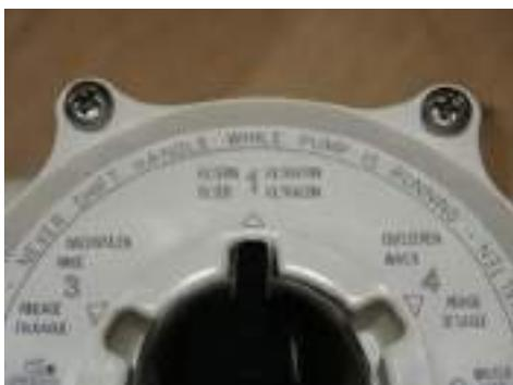
**В режиме фильтрации** вода подается насосом в фильтр, проходит механическую очистку и возвращается в бассейн. Схема движения жидкости в режиме фильтрации описана выше. В режиме фильтрации положение ручки вентиля показано на рисунке 5.
