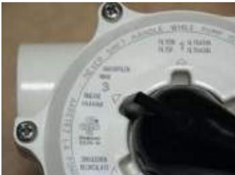
После промывки фильтра необходимо производить **уплотнение** фильтрующего материала (песка) в режиме уплотнения схема движения воды выглядит следующим образом: вода из ванны подается насосом на фильтр, далее проходит прямым потоком через фильтр (сверху вниз) и сбрасывается в канализацию. В режиме уплотнения фильтрующего материала (песка) положение ручки вентиля показано на рисунке 7.
